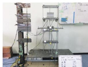
地震に対する建物の安全性と機能性の向上を目的に、地震時の揺れを制御する装置の開発を進めます。この装置(動滑車制振機構)は、構造物に設置された滑車を往復するようにワイヤを張り、ワイヤの端部にダンパーを設置する安価かつ設置自由度の高いシステムです。
